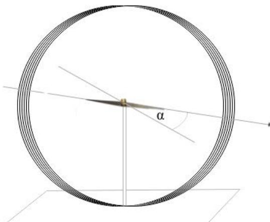
Il piano della bobina viene orientato in modo da contenere l'ago che, a sua volta, è orientato nella direzione della componente orizzontale del campo magnetico terrestre. Quando la bobina è attraversata da corrente, l'ago devia di un angolo  $\alpha$ . Spiegare la causa di questa deviazione.
