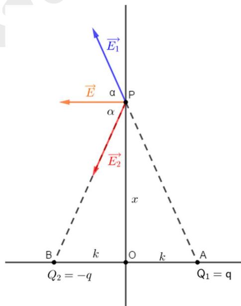
Il campo risultante nel punto P sull'asse del segmento AB è parallelo al segmento AB (quindi orizzontale nel riferimento in figura); il suo modulo è dato dalla somma delle componenti orizzontali dei due campi, ovvero
